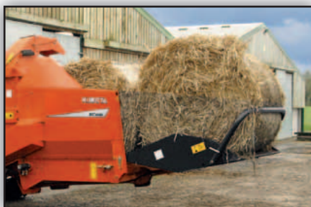
La conception spéciale de la porte arrière permet de transporter une balle ronde supplémentaire.
