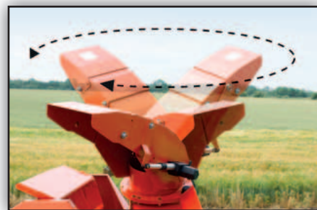
La goulotte pivotante assure une rotation de 260°.
