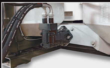
Hydraulische aandrijving (DSX/DSX-W/DSX-W GEOspread)
