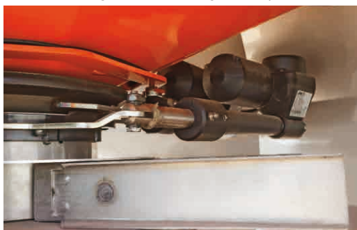
Twee spindelmotoren bedienen het uitstrooppunt (werkbreedte) en de gift op hetzelfde moment.
