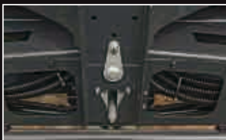
Bloqueo hidráulico de la suspensión pendular
