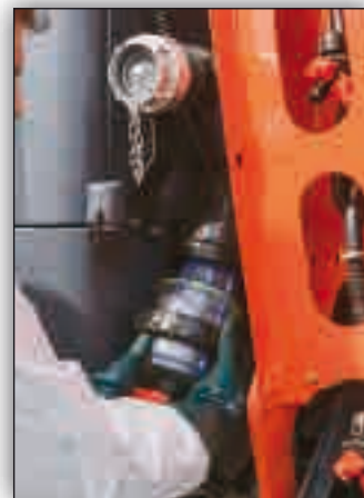
Filtro de succión en contenedor transparente.
