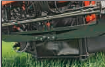
Sistema de amortiguación de oscilaciones para mantener la altura de la barra en todo momento.
