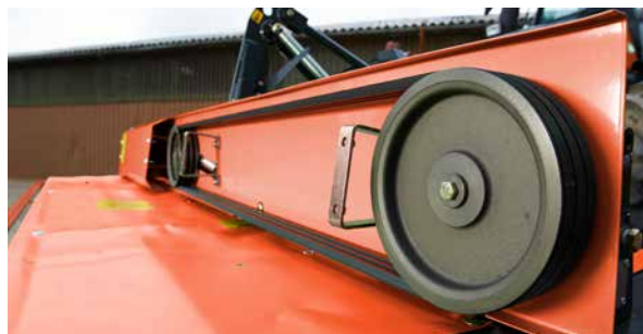
La variazione dei regimi di giri della PTO da 750 a 1000 giri/min si effettua tramite puleggia.
