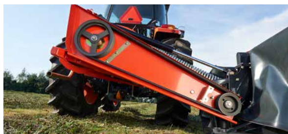
Quattro cinghie a V assicurano un'efficientissima trasmissione della potenza.
