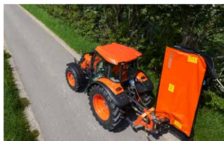
Trasporto stabile e sicuro grazie al posizionamento della falciatrice vicino al trattore.
