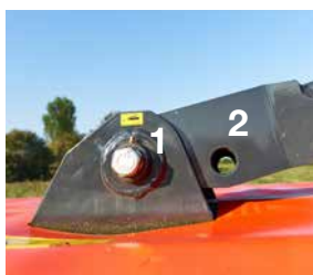
Due opzioni di montaggio per creare una sovrapposizione ottimale in caso di combinazione con una falciatrice frontale.
