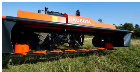
Facile accesso alla barra di taglio grazie alle protezioni frontali e laterali pieghevoli.
