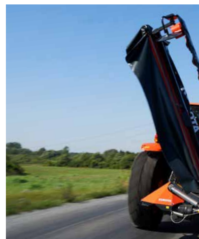
Posizione di trasporto verticale fino a 125°, per una distribuzione ottimale del peso.
