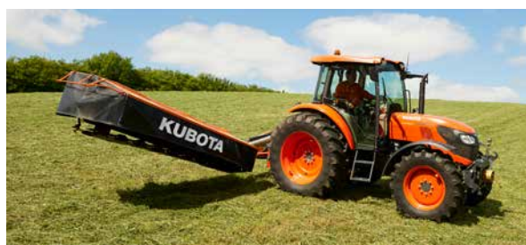
Sollevamento a fine campo tramite cilindro idraulico.
