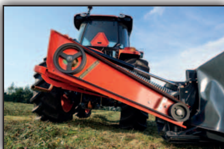
Cztery paski klinowe to doskonałe przeniesienie napędu.
