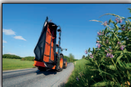
Do transportu kosiarka składana jest do pionu i zabezpieczona blokadą zapewniając dodatkowe bezpieczeństwo na drodze.
