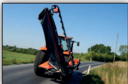
Pozycja transportowa pod kątem 125° zapewnia optymalne rozłożenie wagi.
