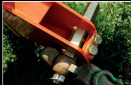
Sworznie zaczepowe posiadają regulację względem szerokości ciągnika.
