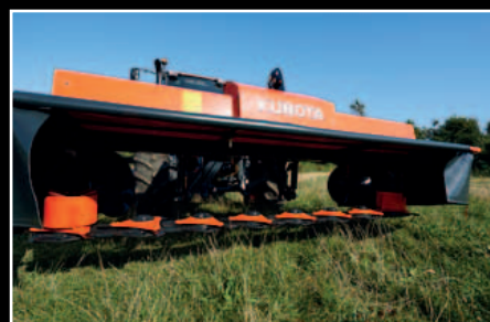
Dobry dostęp do listwy tnącej poprzez podnoszone osłony z przodu oraz z boku.
