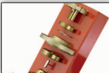
Aby chronić napęd oraz koła zębate kosiarki Kubota posiadają połączenie za pomocą klinu, który ma możliwość ścięcia w przypadku przeciążenia.
