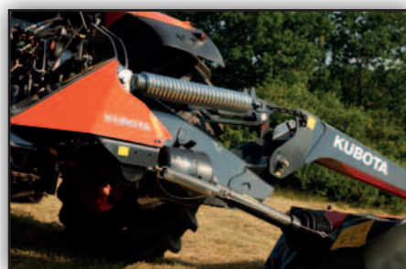
Duże sprężyny odciążające zapewniają doskonałe kopiowanie na całej szerokości roboczej.
