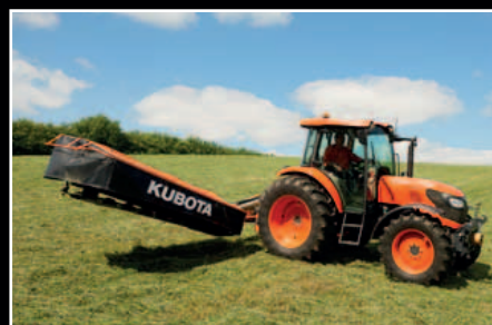
Podnoszenie na uwrociach poprzez siłownik hydrauliczny - bez uruchamiania TUZ ciągnika.
