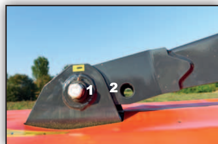
Dwie pozycje zawieszenia pozwalają osiągnąć optymalne pokrywanie się z kosiarką czołową.
