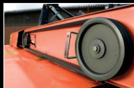
Zamieniając miejscami koła pasowe posiadamy możliwość dostosowania maszyny do 1000 lub 750 obr/min na WOM.
