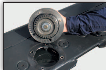
Demontowane górne pokrywy kół zębatych w kosiarkach Kubota to ułatwiona konserwacja.
