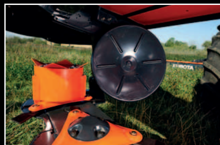
Maszyna wyposażona jest w dwa zawężacze pozwalające na złożenie pokosu do szerokości 2,2 m.
