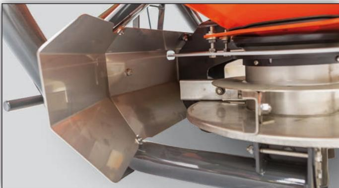
*Cuatro paletas desmontables determinan el ancho de trabajo.*
