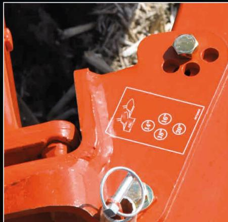
Fácil ajuste manual de los modelos RM2000-RM2005. Con sólo cambiar la posición de un tornillo
