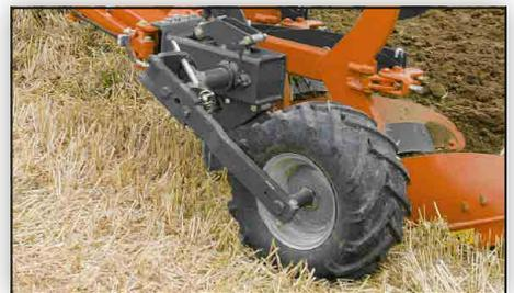
**Trasera combi con ajuste hidráulico**
